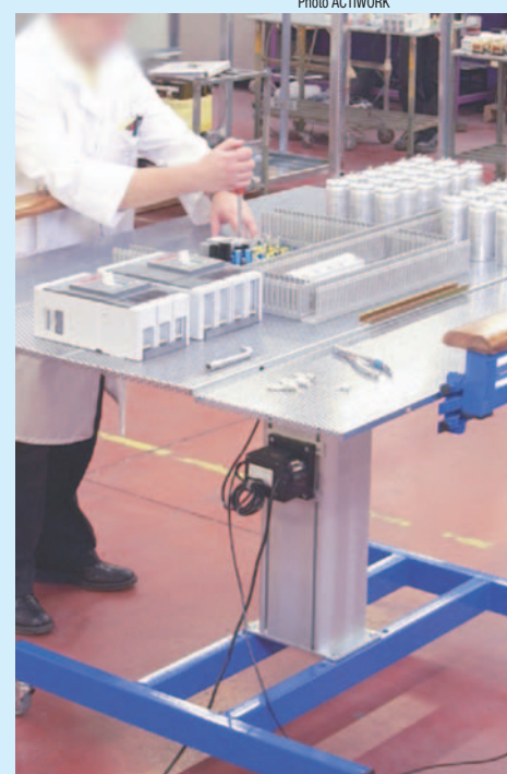
Poste d'assemblage d'armoires électriques (position debout)
