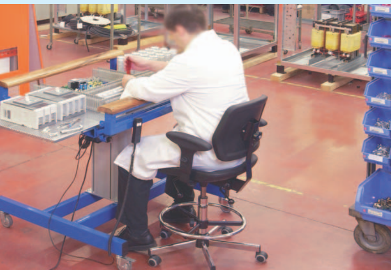
Poste d'assemblage d'armoires électriques (position assise)
